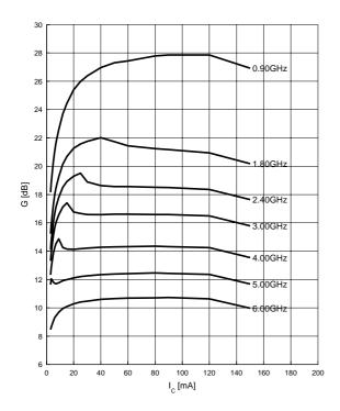
Power gain  $G_{ma}$ ,  $G_{ms} = f(V_{CE})$
